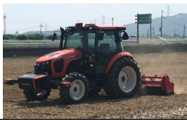
無人ロボットトラクターによる耕起作業
